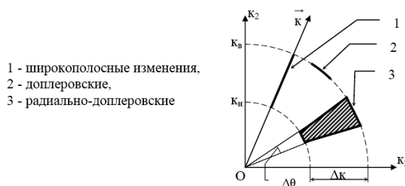
Рис. 1.4. Области в угло-частотном пространстве, соответствующие режимам когерентных измерений
