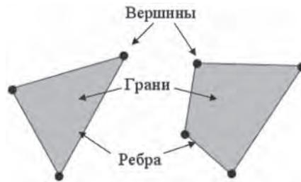
**Рисунок 2.** Элементы полигональной сетки
