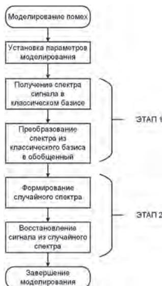
**Рисунок 8.** Алгоритм имитации сигналов спектрально-корреляционным методом
