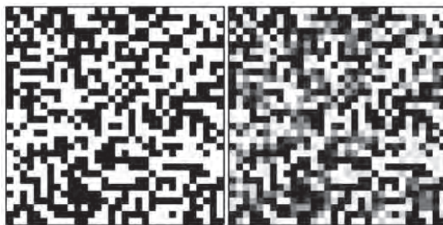
Рисунок 1. Изменения значений пикселей при JPEG-сжатии с качеством 80 % до (слева) и после (справа)
